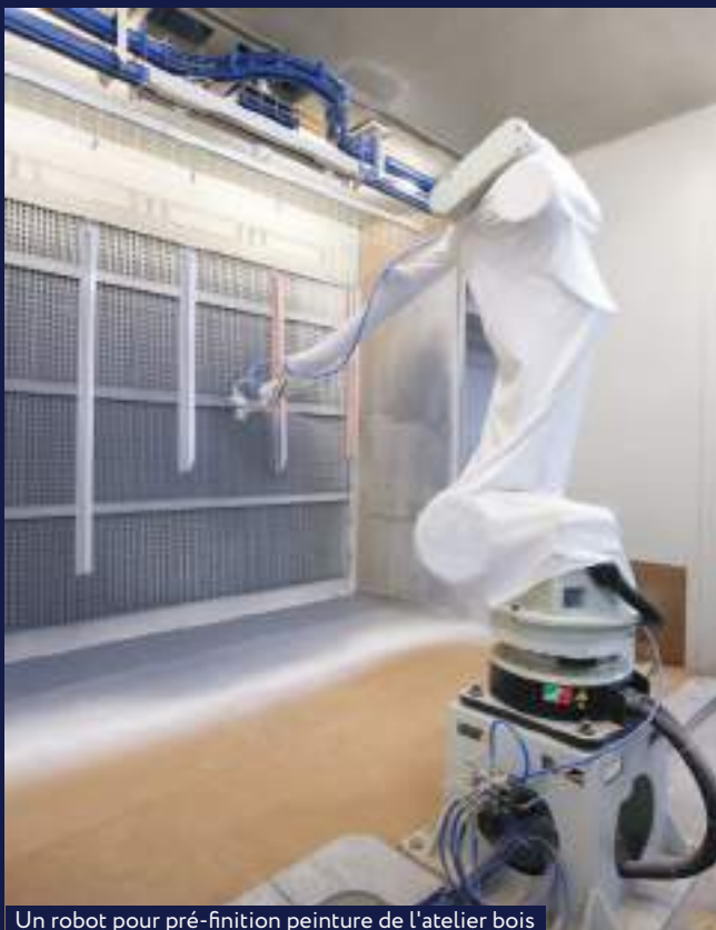
Un robot pour pré-finition peinture de l'atelier bois
