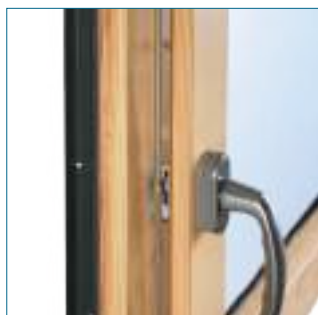
Vue de détail épaisseur 83 mm sur ouvrant (60 mm de bois + 23 mm d'aluminium)
